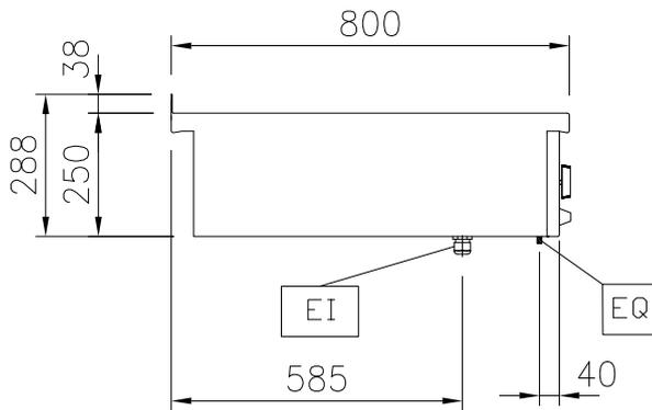
EI = Conexión eléctrica (energía)
